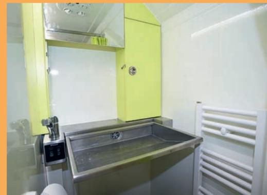
Le lavabo en aluminium se relève (d'où le positionnement de la bonde face à l'utilisateur) pour permettre d'utiliser le W.-C. nautique.
