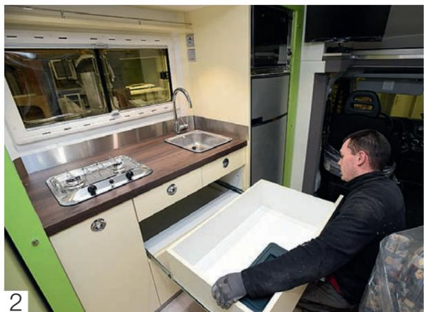
1/2. Sur ce véhicule en cours de réalisation, la cuisine a été intégrée dans la partie mobile du slide out, afin de glaner de précieux centimètres dans l'habitacle.
